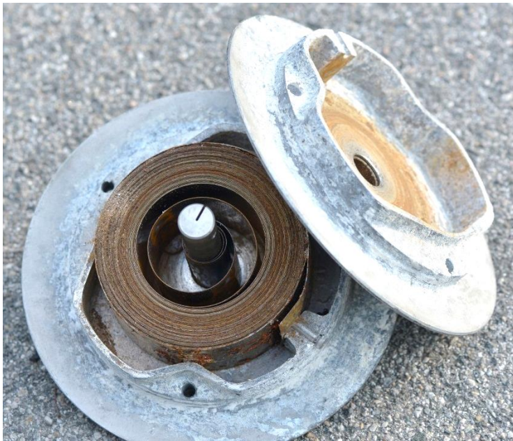
Korrodiertes Gehäuse und Spiralfeder
