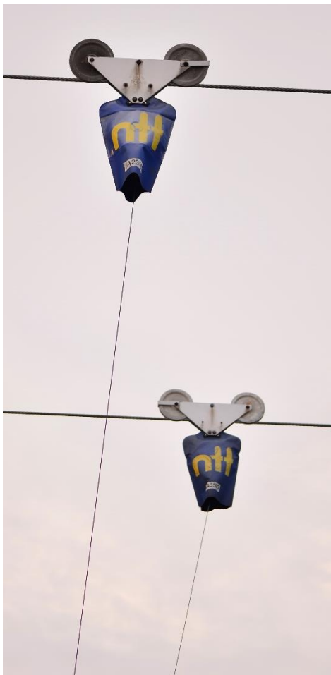
Wetterschutzhauben bei Verladestationen für Kesselwagen und Tankzüge
