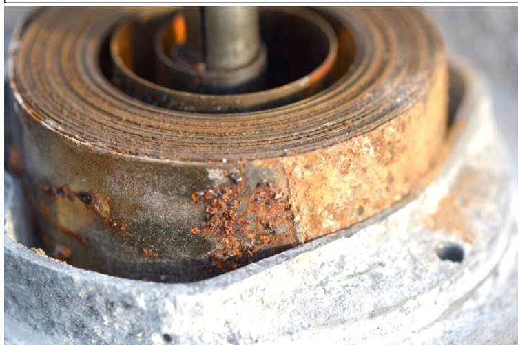
Starke Korrosionsschäden an der Spiralfeder und der Federhalterung
