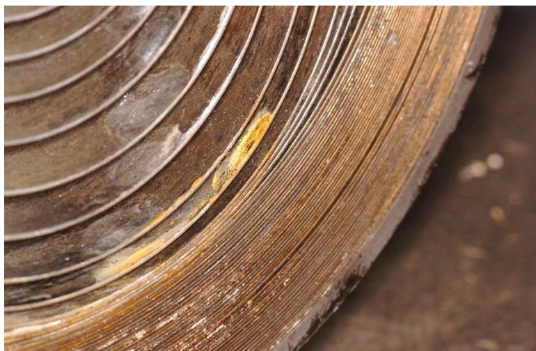
Leichte Korrosion der ca. 35 m langen Spiralfeder
