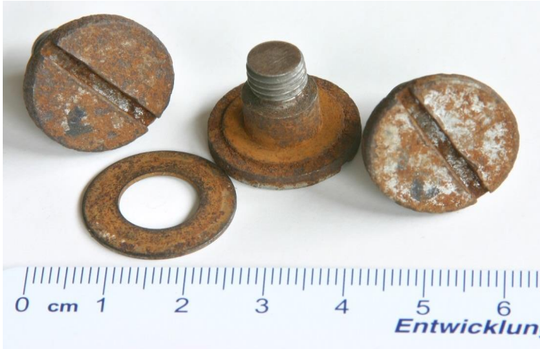
Korrodierte Tellerfeder und Brems- Justierschrauben (waren verzinkt)
