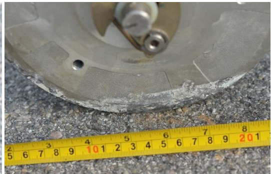
Korrodiertes Gehäuse und Spiralfeder
