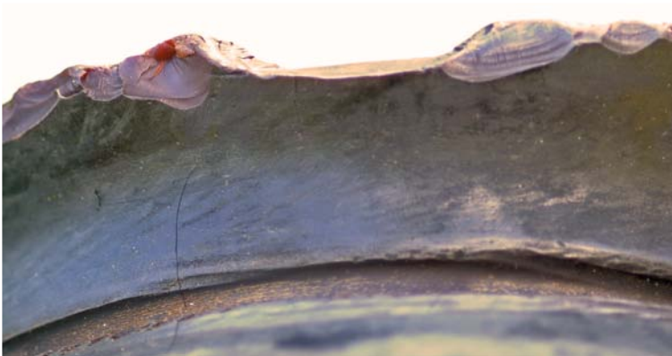
Ausgebrochene Borde an der Spillscheibe aus Vulkolan® einer Rettungswinde
