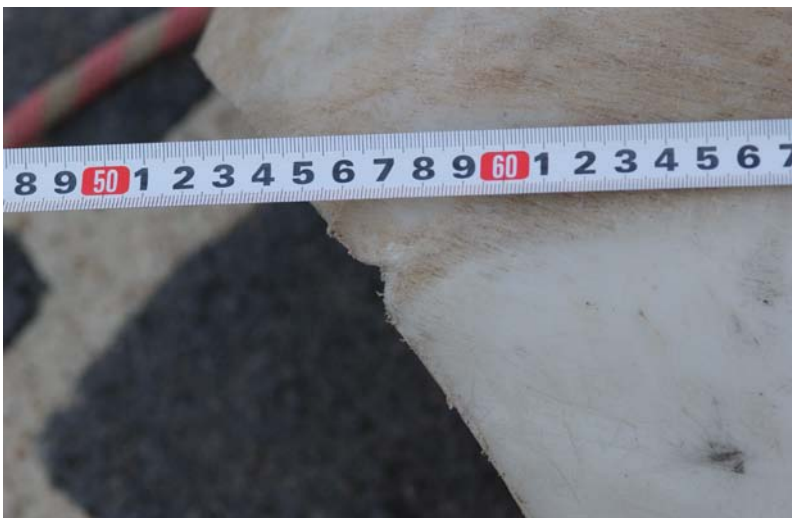
Einriß der Biegefalte an einer Trage aus Kunststoff (13 Jahre alt) durch mechanische Beanspruchung — kein Alterungsschaden
