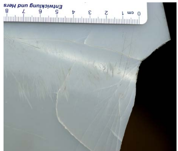
Bruchlinie, Risse und Schrammen an einer überalterten Trage aus Polyamid
