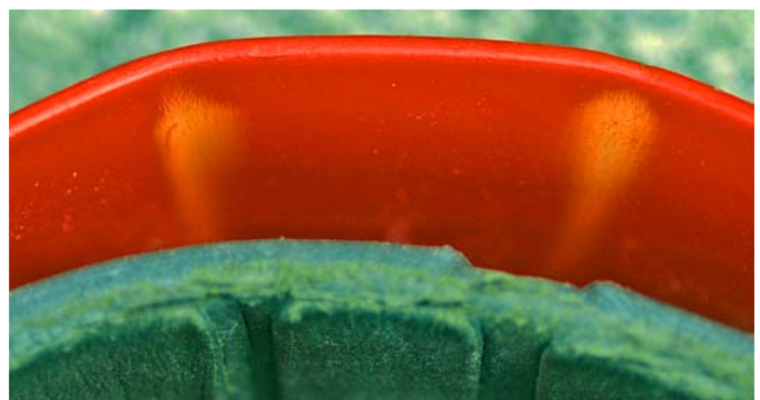
Weißbruchstellen an einem Arbeitsschutz- / Bergsteigerhelm
