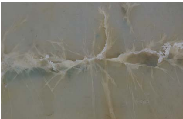
Polyethylen- Kanister (ca. 5 l) mit Natronlauge (zum Abbeizen) über 15 Jahre befüllt; dessen Boden durch das Eigengewicht des Inhalts (1/2 voll) beim Anheben weggebrochen war
