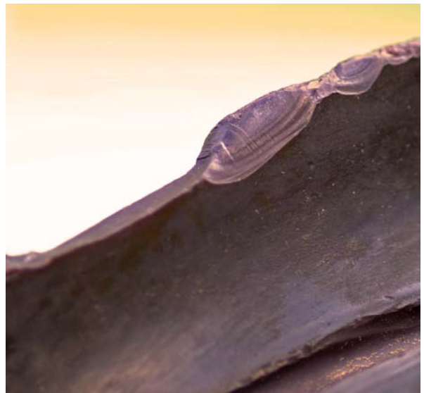
Ausgebrochene Borde an der Spillscheibe aus Vulkolan® einer Rettungswinde
