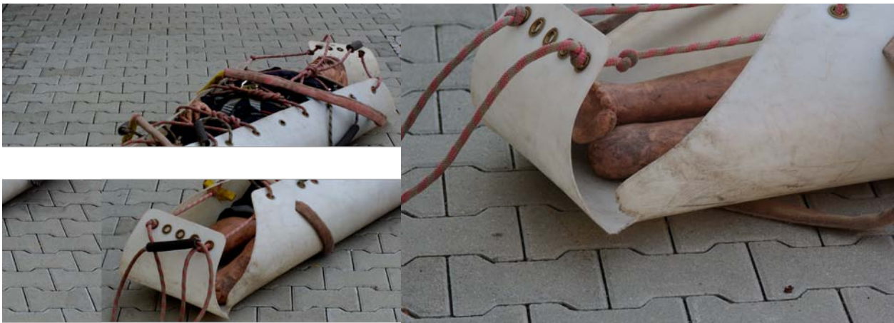
Einriß der Biegefalte an einer Trage aus Kunststoff (13 Jahre alt) durch mechanische Beanspruchung — kein Alterungsschaden
