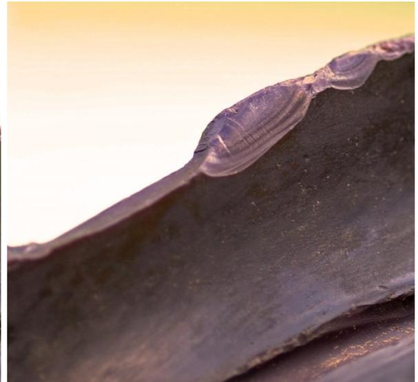
Ausgebrochene Borde an der Spillscheibe aus Vulkollan® einer Rettungswinde.
