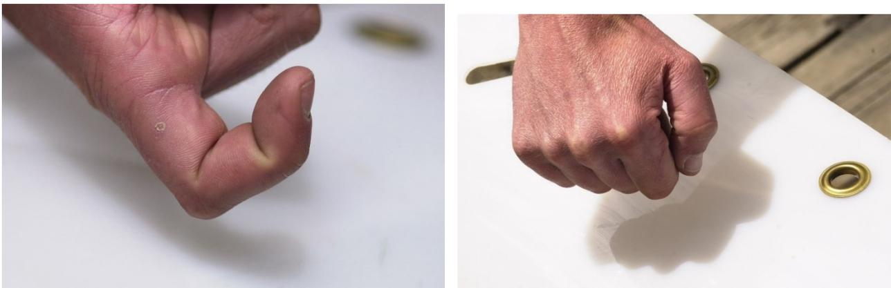
Klangprobe durch Anklopfen mit einem oder mehreren Knöcheln.
