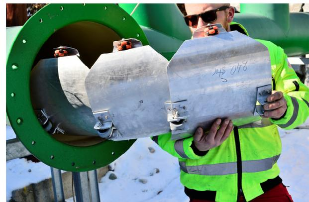
Glieder– Befahrwagen beim Einlegen in eine Rohrleitung Ø 600 mm.
