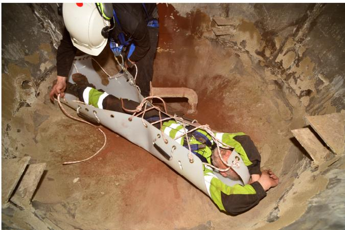
Einbetten einer auszubringenden Person auf dem Klöpperboden einer Destillationskolonne.
