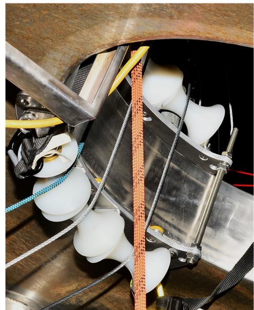
Am Schrägflansch geklemmte Seilumlenkung für 3 Sicherungs– und Rettessysteme.
