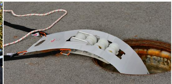
Rutschplatte über dem Rollen- Seilschutz teilelastisch.
