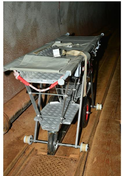
Universalwagen mit Gleisfahrwerk.
