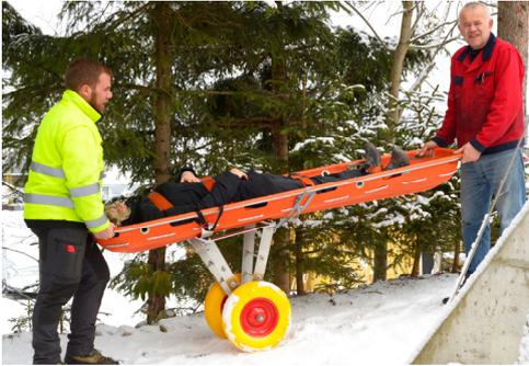
Zwillings- Fahrwerk — für leicht seitlich geneigte Strecken — unter einer Korbtrage.
