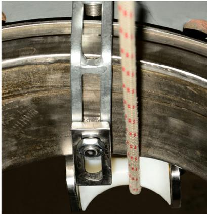
Seilführungssattel mit Paraboloidrolle zur Umlenkung eines Faserseils innen nach oben. Die Gleitplatte ist nicht angebracht.
