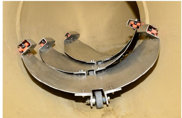
Glieder– Befahrwagen in einer Rohrleitung Ø 600 mm vor einem Bogen R 900 mit Schweißstoß.
