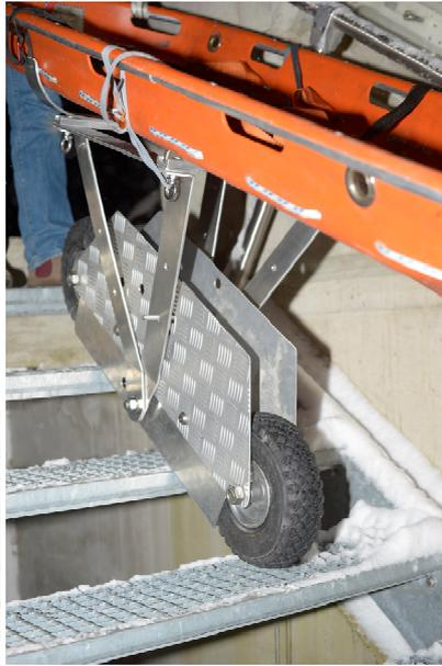
Treppenfahrwerk Universal unter einer Korbtrage.
