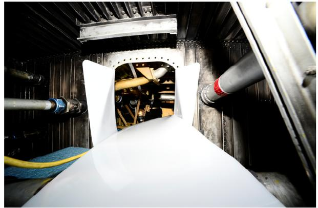
Rutschplatte mit Flaps in einem Flugzeugtank.
