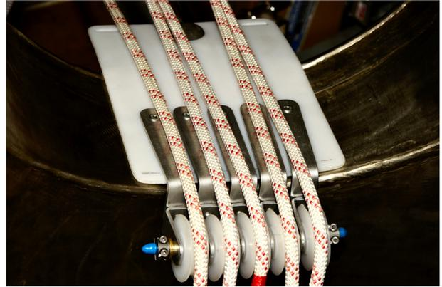
Auf einer Gleitplatte montierter Umlenkrollensatz.
