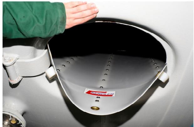
Die Einfahröffnung wird unten und seitlich um nur 3 mm verkleinert und alle Kanten werden abgedeckt.
