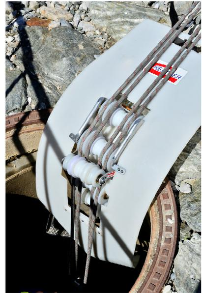
Rollen– Seilschutz teilelastisch mit Niederhalter unter der Gleitplatte an einem Kanaleinstieg.
