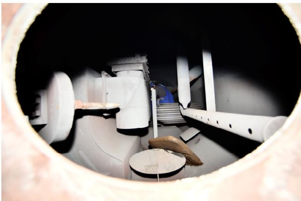
Starke Niveauunterschiede durch Einbauten werden — falls erforderlich — durch Unterstützungen der Ofenrutsche ausgeglichen.
