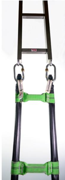
Steckleitern bestehen aus 1,0 m langen und 200 mm breiten Elementen und können im Behälter über integrierte und unverlierbare Steckverbinder zusammengesetzt werden. Sie sind auch werkzeuglos wieder in ihre Einzelstücke zerlegbar. Die Steckverbinder sind auf Zug belastbar, sodass die Steckleiter auch frei hängend eingesetzt werden kann.
