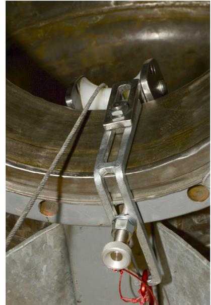
Seilführungssattel mit Paraboloidrolle zur Umlenkung eines Stahlseils innen nach unten. Die Gleitplatte ist nicht angebracht.
