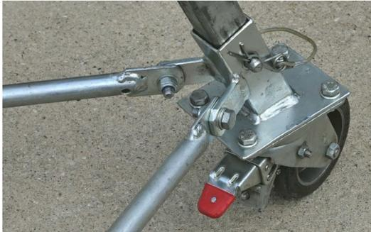
Lenkrolle des Fahrwerks mit Spreizstangen.
