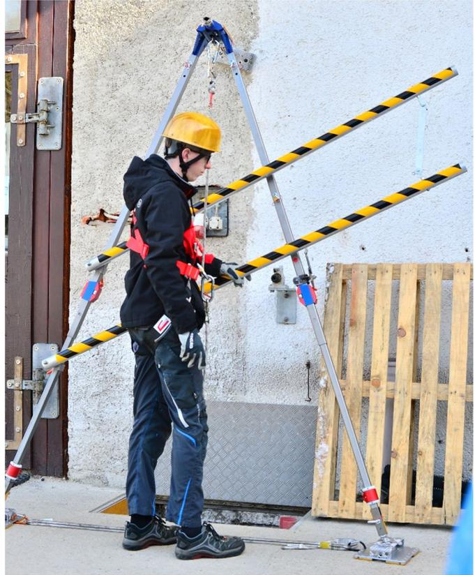
2- / 3- Bein mit selbstschließender Durchgangssperre.
