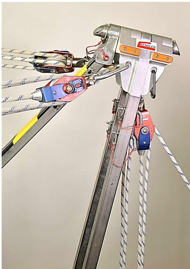
Kopf des Einbeins mit 2 Abspannungen durch Flaschenzüge und Abstützung nach hinten durch das Pendelbein.
