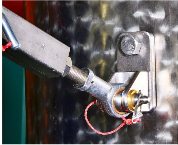
Anschraublasche zur Befestigung der Abstützung an einer Behälter- oder Bauwerkswand.
