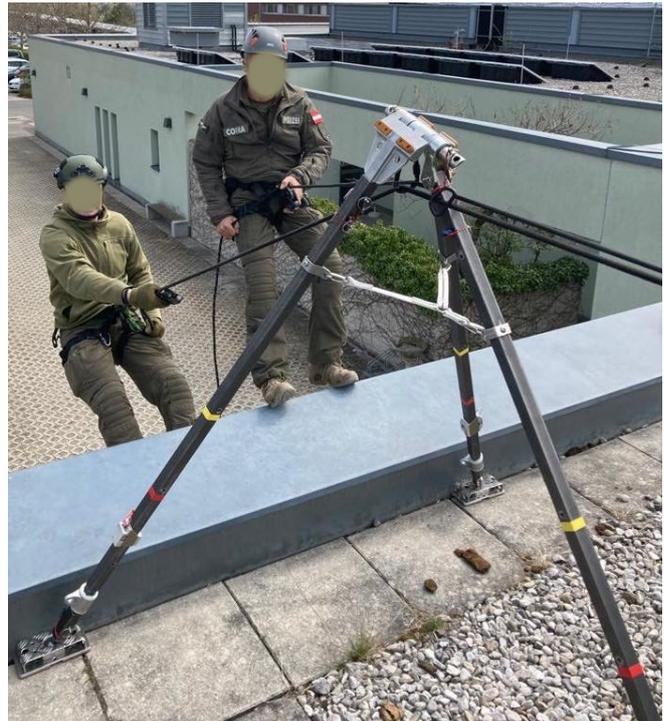
Dreibein an einer Attika abgestützt nach hinten und zurückgehängt nach hinten.
