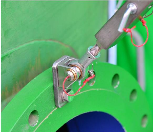
Befestigung des Pendelbeins an einem stehenden Flansch zur Abstützung und zugleich als Rückfallsicherung.
