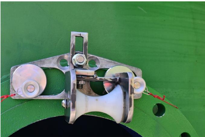
Außenumlenkung am Flansch befestigt.
