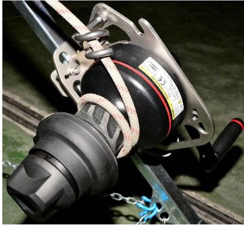
Spillwinde von Harken für Faserseil an einem der
