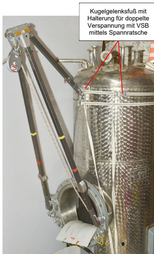
Kugelgelenksfuß mit Halterung für doppelte Verspannung mit VSB mittels Spannratsche
