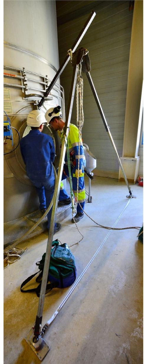
Zweibein freistehend, abgestützt am Behälter und mit Spanngurt gegen Rückfallen gesichert. Flaschenzug in direkter Anwendung zum Retten.
