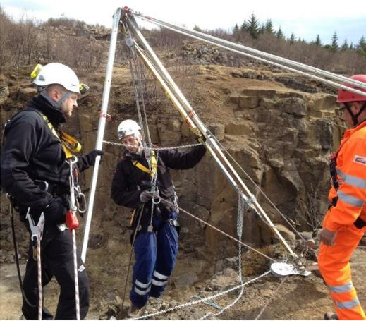
2- / 3- Bein als Zweibein zurückgehängt mit dem Rückhalteflaschenzug in einem Steinbruch (älteres Modell mit Spreizkette).
