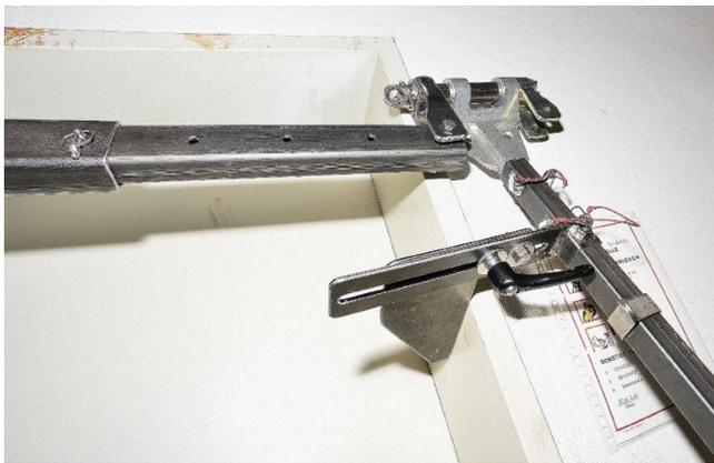
Seitensicherung der Zweibein Traverse an der Zarge eines Türstocks.
