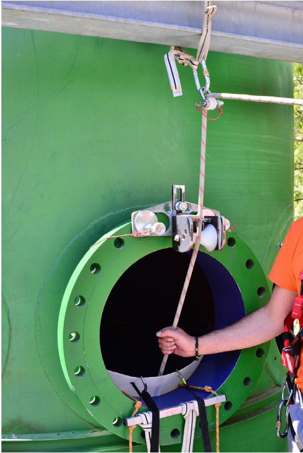
Außenumlenkung am Flansch für Stahl- und Faserseile zur Optimierung der Ausbring- Zugrichtung.
