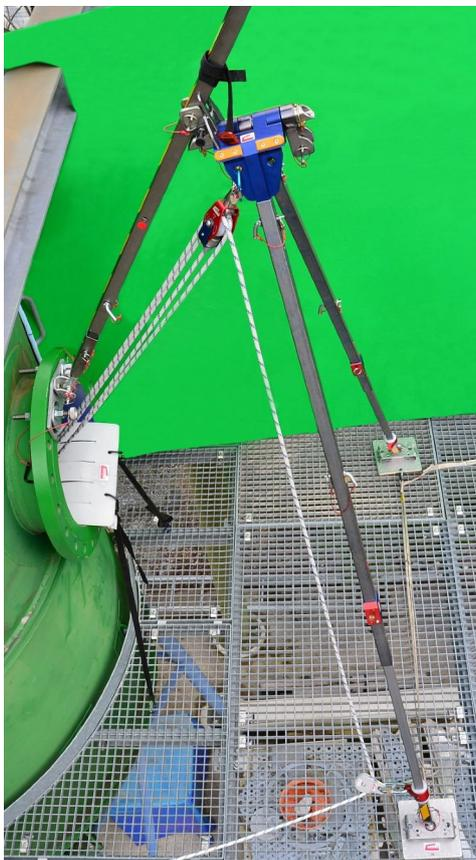
Abgestützt nach vorne am Flansch oder Behälter.
