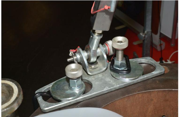
Flanschadapter mit Exzenterscheiben zur größtmöglichen Abdeckung verschiedenster Lochbilder.
