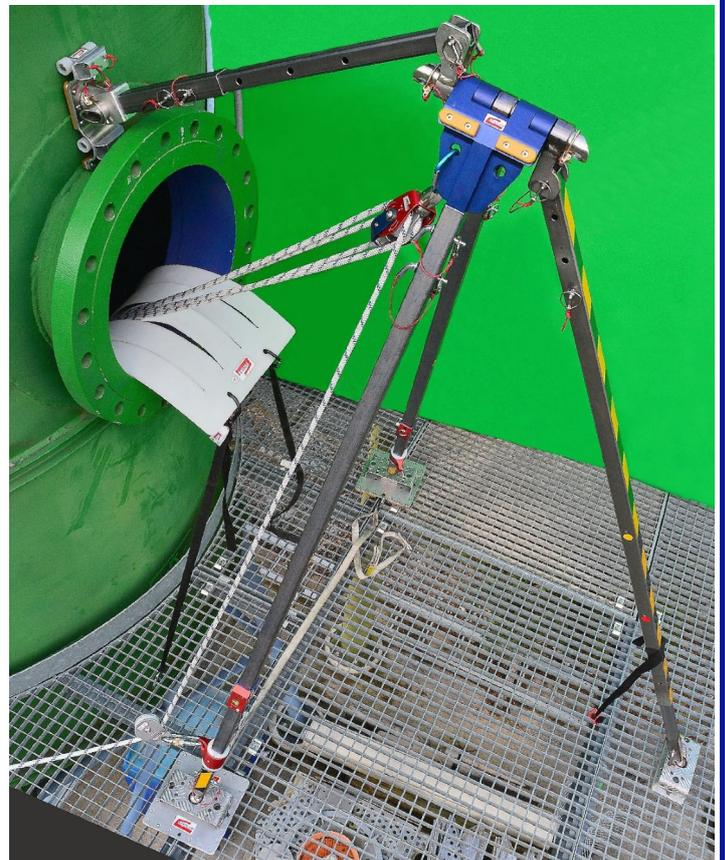
Abgestützt nach vorne am Behälter und nach hinten mit dem Pendelbein.
