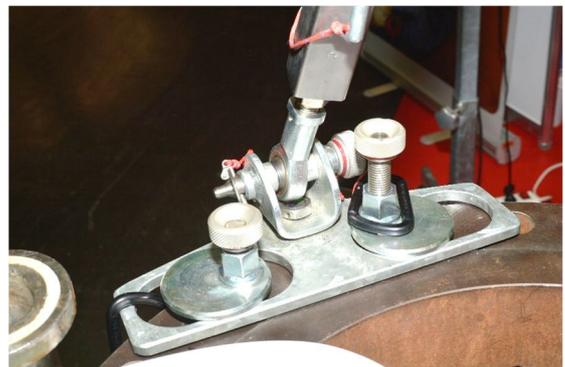
Mit 3 Flanschadaptern kann das Dreibein als solches oder in Auslegerstellung an Schraubflanschen befestigt werden.
