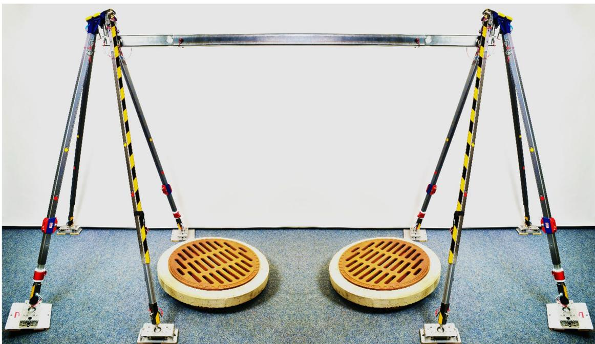
8- Bein- Bock aus 2 Stück 3- Beinen und 2 Pendelbeinen mit Stecktraverse über zwei Schachteinstiegen; Positionierungs- und Rettssystem noch nicht eingehängt.
