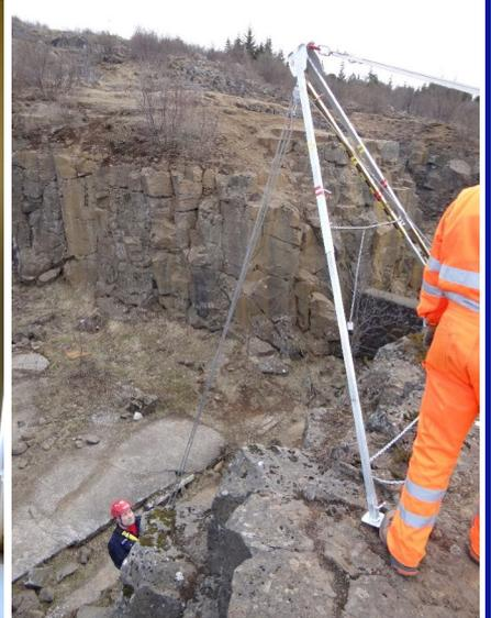
2- / 3- Bein als Zweibein zurückgehängt mit dem Rückhalteflaschenzug in einem Steinbruch (älteres Modell mit Ketten).
