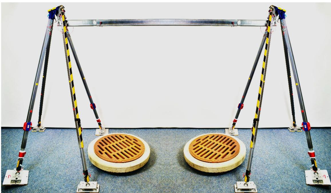
8– Bein– Bock aus 2 4– Beinen mit Stecktraverse über zwei Schachteinstiegen; Positionierungs– und Rettungssystem noch nicht eingehängt.
