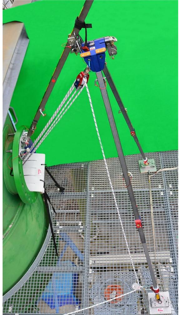
2- /3- Bein als Zweibein am Boden stehend und am Flansch abgestützt.
