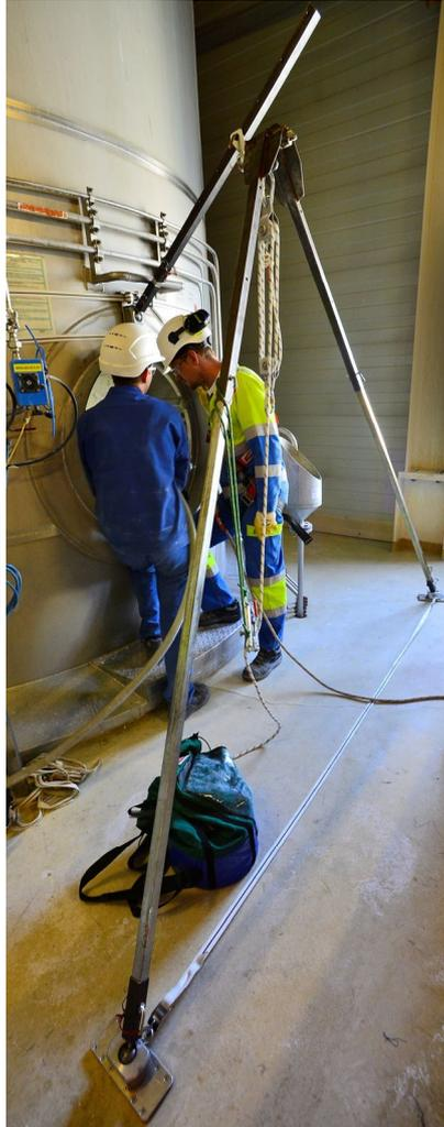
2- / 3- Bein als Zweibein abgestützt und abgehängt an einem isolierten Rührwerksbehälter.
