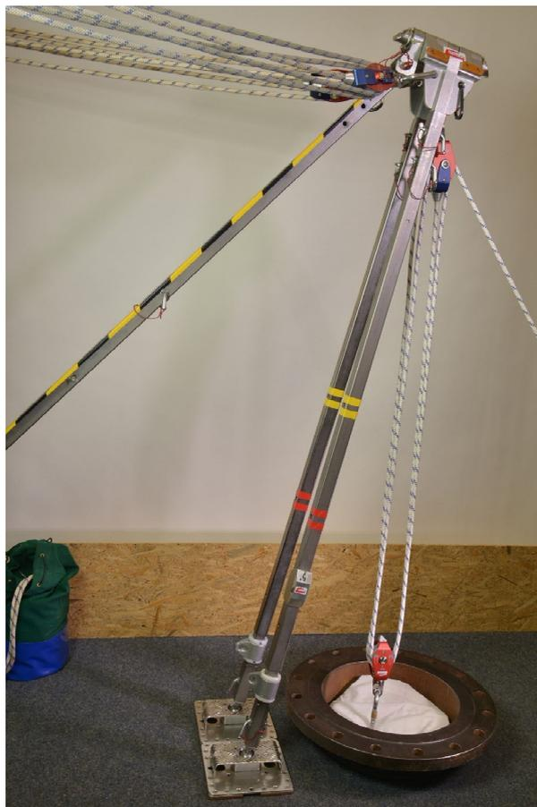
"Einbein" abgehängt mit 2 Flaschenzügen und abgestützt nach hinten.
