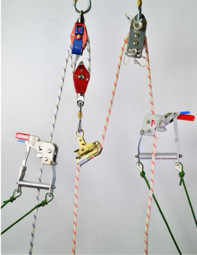
Indirekter Flaschenzug zum Aufseilen nach dem Abseilen über große Höhen mit einem Pendel- Abseilgerät.
