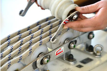
Aufsetzen / Abnehmen der Niederhalte– Seilführung.
