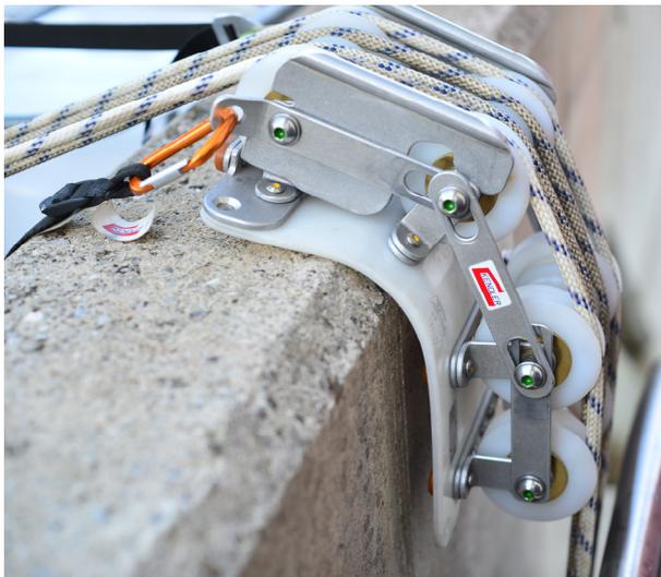
120°– Umlenkung der Seilstränge des Flaschenzugs.
