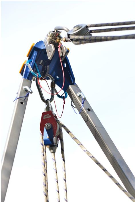
2- / 3- Bein als Zweibein abgehängt mit einem Rückhalte- Flaschenzug (29 1015) und zum Auf- und Abseilen mit einem Rette- Flaschenzug mit Mehrfachwirbel(29 1100) ausgestattet.
