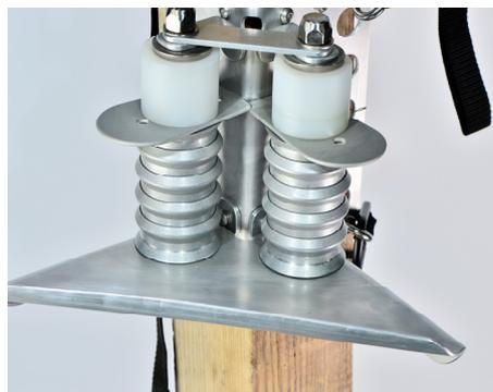
Kegel– und Zylinderrollen des Seiten– Rollenseilschutzes.
