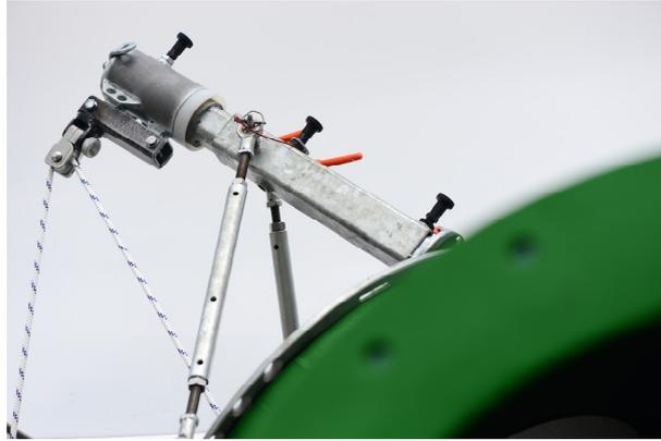
Schrägflanschkonsole mit Schwenkrolle zur Umlenkung des Retteseils beim indirekten Flaschenzug.
