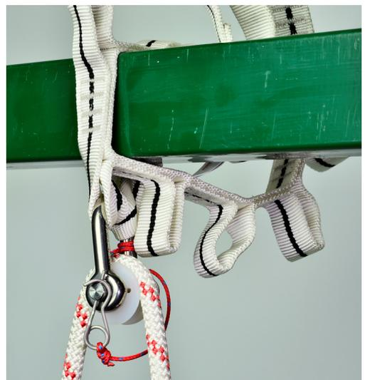
Schäkelrolle an einer Stufenschlinge mit Seilumlenkung ca. 70 mm unter der Trägerunterkante.
