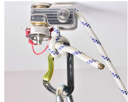
Schwenkrolle in einer Betondecke; zur Umlenkung der Hilfshubseils beim einem indirekten Flaschenzug.
