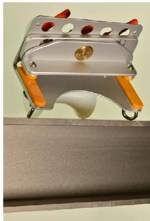
Unterseite der Exzenterklemmung.
