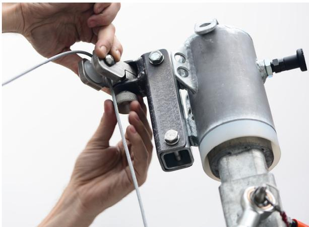
Schwenkrolle samt Stahlseil des indirekten Flaschenzugs beim Einsetzen in den Kopf der Schrägflanschkonsole.
