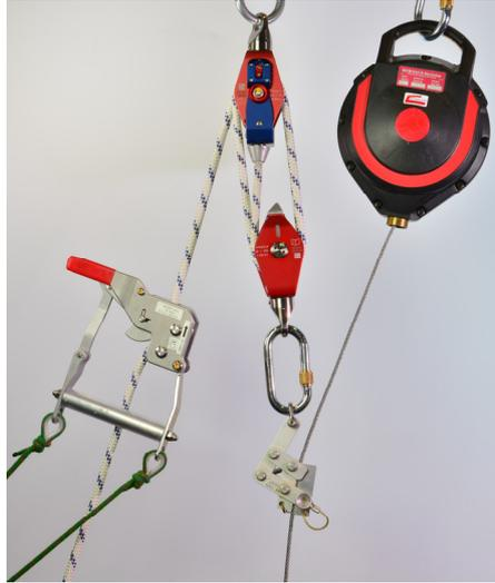
Indirekter Flaschenzug zum Retten aus einem Höhensicherungsgerät ohne Rettungshub.
