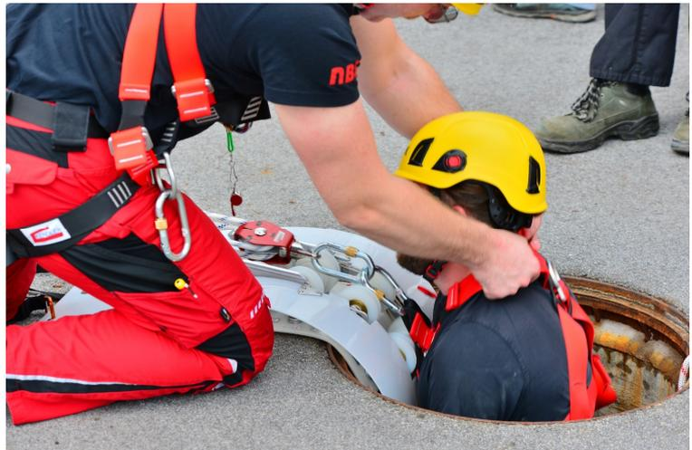
Retten aus einem engen Schacht mit dem Rollen– Seilschutz teilelastisch, Gleitplatte und Flaschenzug mit Mehrfachwirbel; ein Dreibein etc. ist nicht erforderlich.
