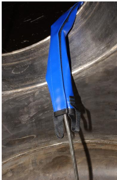
Seilschutzschlauch aufklettbar als Schutz für ein Kabel an einem Mannloch.
