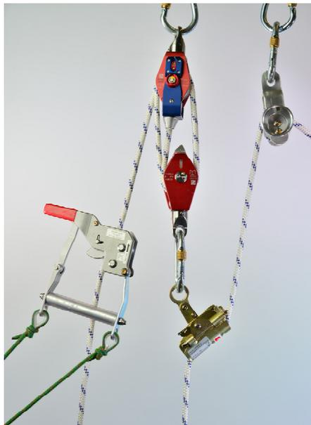
Aufseilen mit dem Flaschenzug mit der Retteklemme nach dem Abseilen mit einem Einseit- Abseilgerät.
