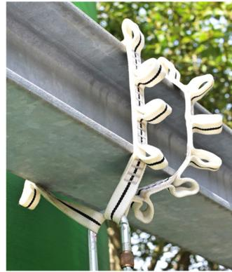
Stufenschlinge an einem Träger über einem Mannloch.
