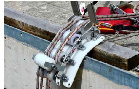
Niederhalte– Seilführung auf dem Rollen– Seilschutz.
