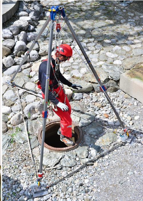
2- / 3- Bein als Zweibein mit verschwenktem Pendelbein ausgestattet mit dem Flaschenzug mit Mehrfachwirbel zum Positionieren und zum Retten.
