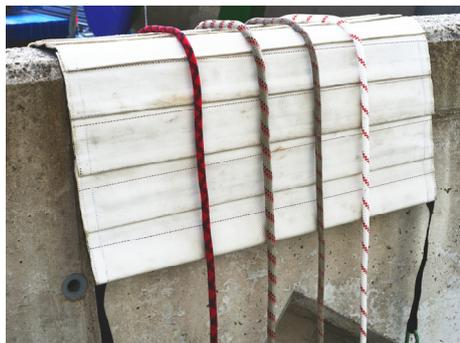
Seilschutz auf einer Betonbrüstung durch zusammengenähte ausgediente Feuerwehrschräume.
